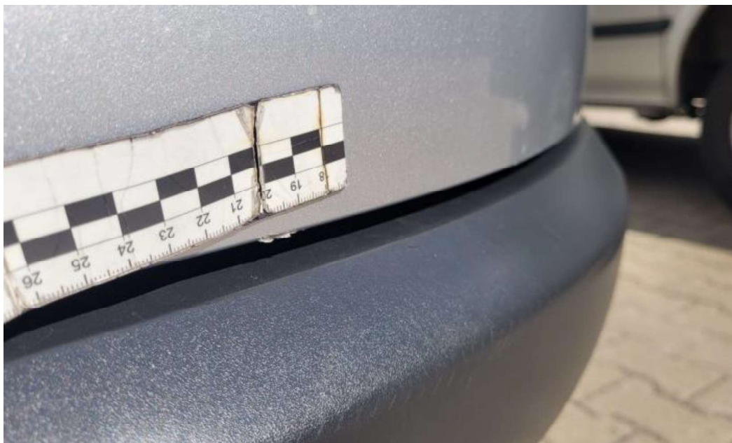
Fot. 25. Pokrywa - zarysowanie 1
